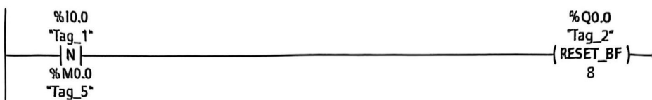
图 2-19 复位位域指令的梯形图程序
